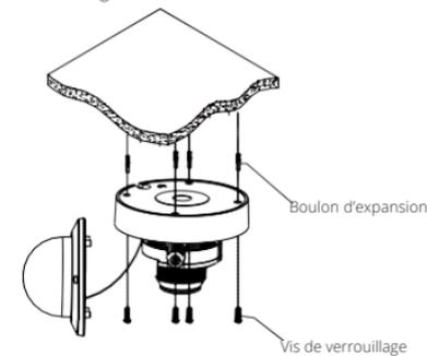
Utilisez la position indiquée sur l'autocollant de position pour percer les trous nécessaires au montage de la base de la caméra. Insérez le boulon d'expansion dans les trous. Faites correspondre les ouvertures de montage de la base à la position des boulons d'expansion, puis placez les vis de montage à travers l'ouverture de montage de la base dans le boulon d'expansion. Serrez les vis de montage pour vous assurer que la base de la caméra est bien montée.
